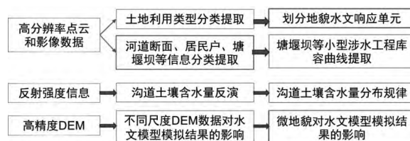
图4 无人机技术在山丘区小流域洪水计算中的应用
