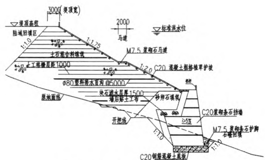
图8 典型直斜复合式堤防示意图
